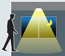
Is de sensor enige beweging opmerkt, gaat de lamp op volle sterkte (100% helderheid) branden. Zolang er beweging is, blijft de lamp branden.
