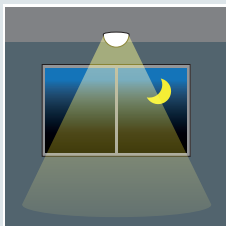
De lamp staat standaard aan, maar op een laag lichtniveau dat is ingesteld.
