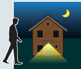
Bij onvoldoende omgevingslicht reageert de sensor op bewegingen. Zodra hij beweging detecteert, gaat de verlichting op maximaal ingestelde sterkte branden. Zolang er beweging is, blijft de lamp branden.
