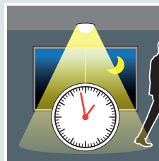
Na een bepaalde (instelbare) wachttijd dimt de sensor de lamp naar een lager lichtniveau (ook dat is instelbaar). Zolang er beweging is, blijft de lamp branden.
