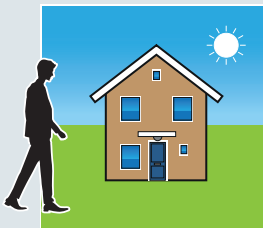
Bij voldoende omgevingslicht, reageert de sensor niet op bewegingen. De lamp blijft uit.
