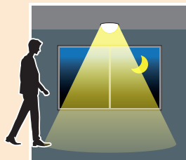
Bij onvoldoende omgevingslicht reageert de sensor op bewegingen. Zodra hij beweging detecteert, gaat de verlichting op maximaal ingestelde sterkte branden.
