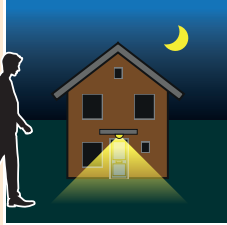
Bij onvoldoende omgevingslicht reageert de sensor op bewegingen. Zodra hij beweging detecteert, gaat de verlichting op maximaal ingestelde sterkte branden. Zolang er beweging is, blijft de lamp branden.
