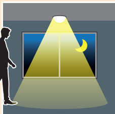
Is de sensor enige beweging opmerkt, gaat de lamp op volle sterkte (100% helderheid) branden. Zolang er beweging is, blijft de lamp branden.
