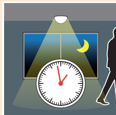
Als de sensor binnen een bepaalde (instelbare) wachttijd geen bewegingen meer heeft opgemerkt, dimt de lamp geleidelijk tot het standaard (lage) lichtniveau weer is bereikt.
