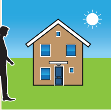
Bij voldoende omgevingslicht, reageert de sensor niet op bewegingen. De lamp blijft uit.
