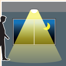
Bij onvoldoende omgevingslicht reageert de sensor op bewegingen. Zodra hij beweging detecteert, gaat de verlichting op maximaal ingestelde sterkte branden.
